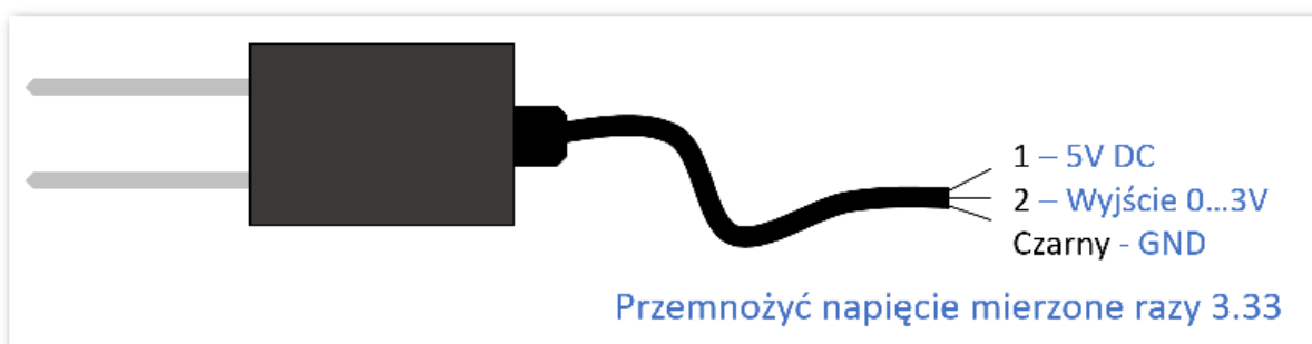
Rysunek 2 Podłączanie sond dla trybu 0...3V
